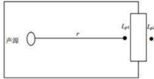
图 6.3-1 室内声源等效为室外声源图例
