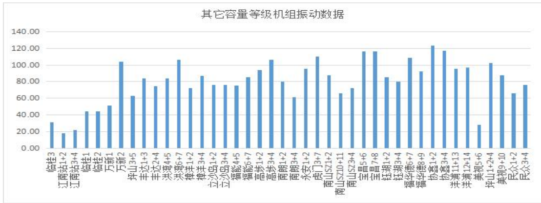
图 27 其他容量等级气电机组振动 数据显示，各机组振动幅值均在合格范围内。
